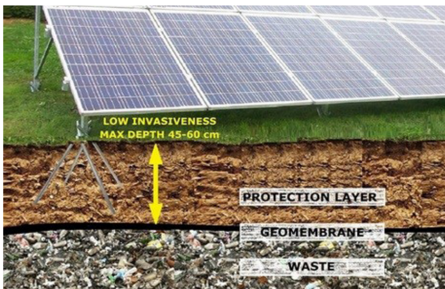
Joonis 2.4 Geomembraani kahjustust vältiv karkassilahendus, allikas EPEA
